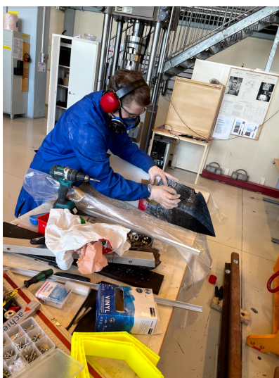
Figur 11: personlig verneutstyr ved pussing av epoxy-dekket skrog
