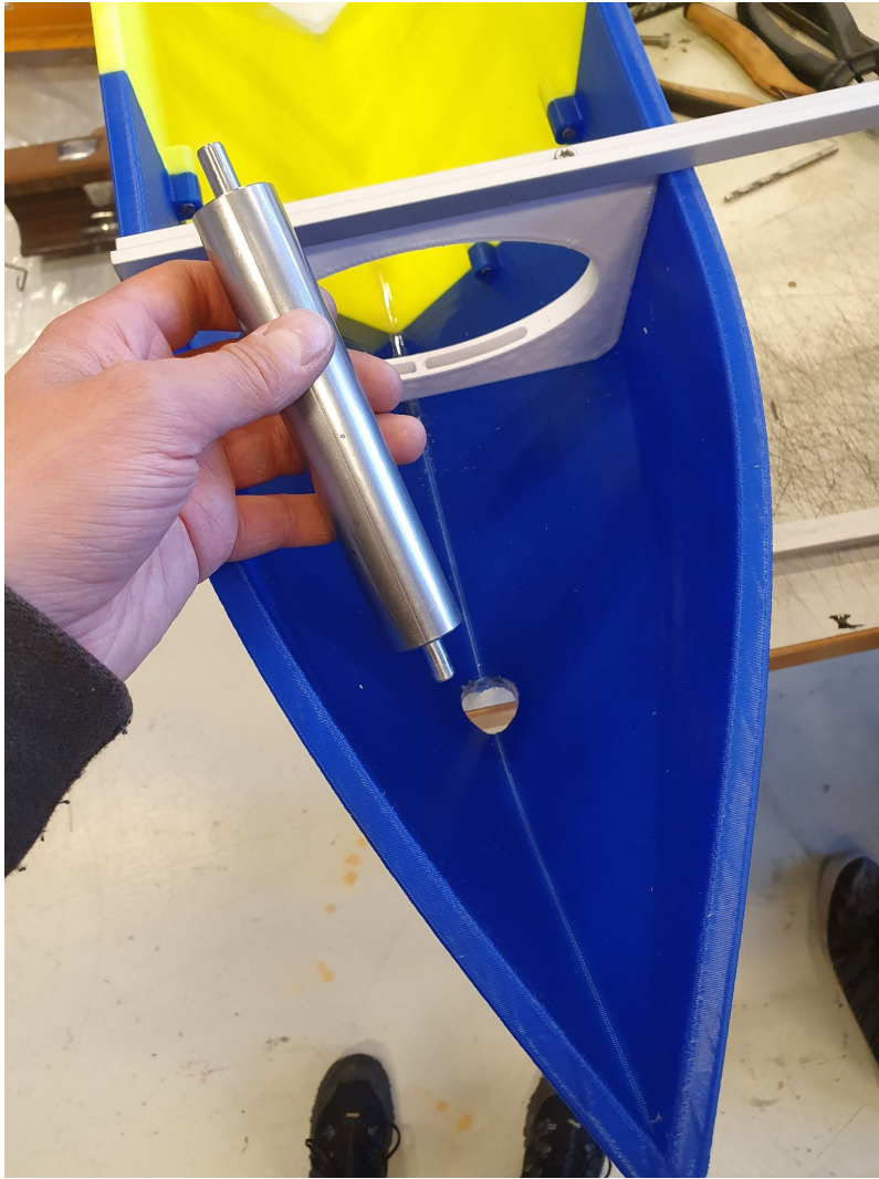
Figur 10: styreaksel-assembly og delvis sammenstilt skrog
